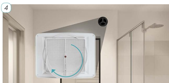
Au besoin commencer à faire tourner la Fixation Flex quand la vis est partiellement vissée.
